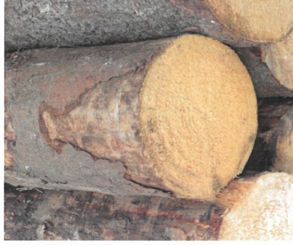
Zamodráání menší než ¼ tloušťky čela čepu
